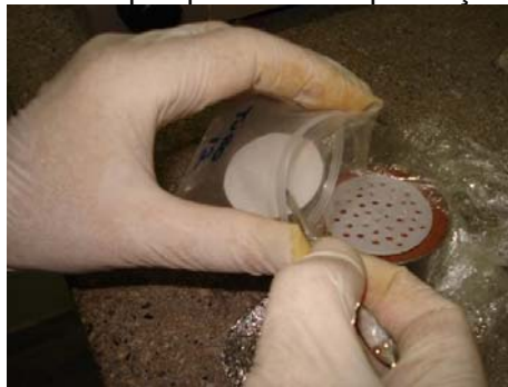
Figura 3. 54 - Colocação do papel filtro úmido no plástico zipado.
