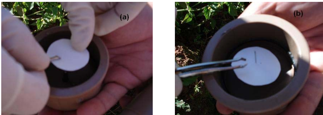
Figura 3. 43 (a) (b) – Colocação do papel-filtro de 4,5 cm no tubo.
