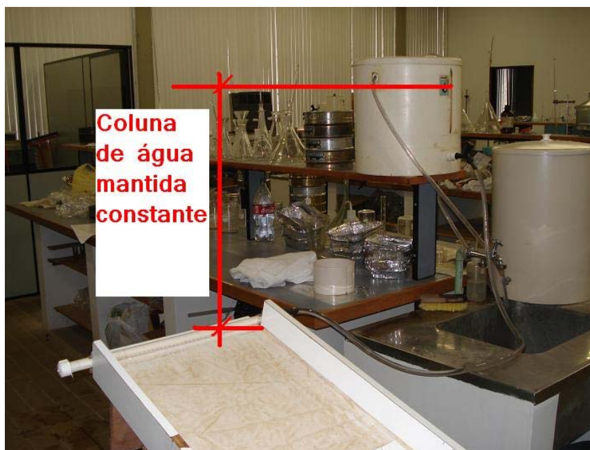
Figura 3. 61 - Detalhe do controle de vazão.
