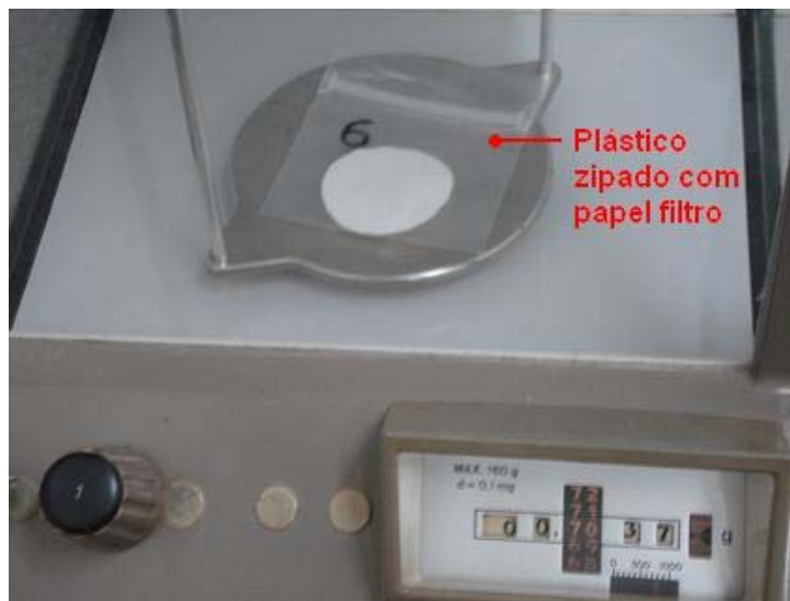
Figura 3. 51 – Pesagem do papel filtro em balança de precisão de 0,1 mg.
