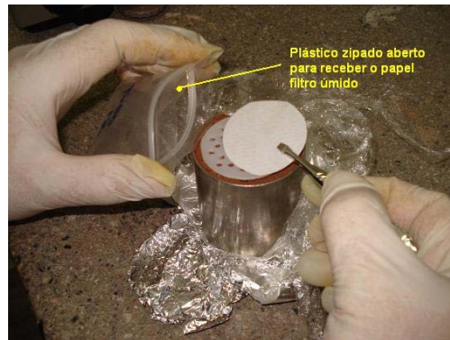
Figura 3. 53 – Ensaio de papel filtro para medir sucção total – pesagem do papel úmido após período de equalização.
