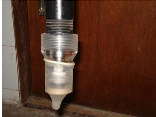
Figura 3. 34 - Preservativo com água deaerada para manter a pedra porosa saturada.
