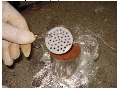
Figura 3. 55 - Detalhe da placa perfurada.
