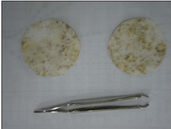
Figura 3. 46 – Papel-filtro contaminado por fungo.
