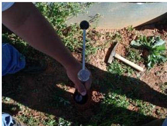
Figura 3. 2 – Cravação do cilindro de amostragem.
