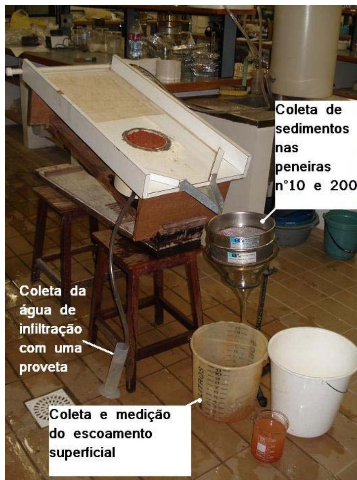
Figura 3. 58 - Equipamento para realização do ensaio de Inderbitzen.
