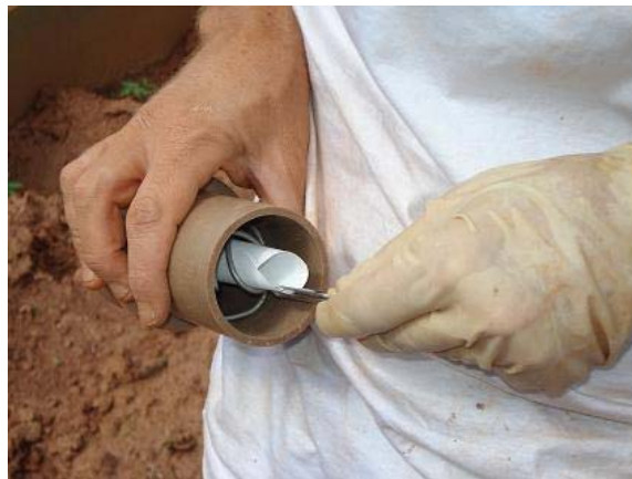
Figura 3. 44 - Colocação do papel filtro de 7 cm enrolado no arame espiralado dentro do tubo.
