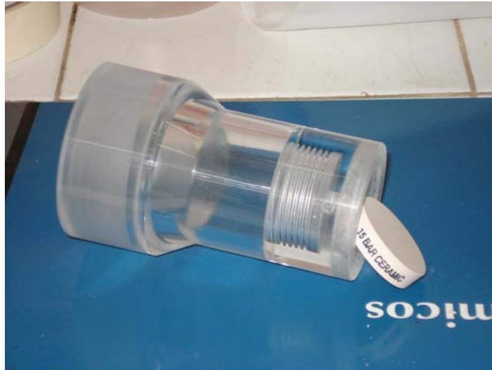
Figura 3. 21 – Corpo acrílico e pedra cerâmica porosa de 15 bar.
