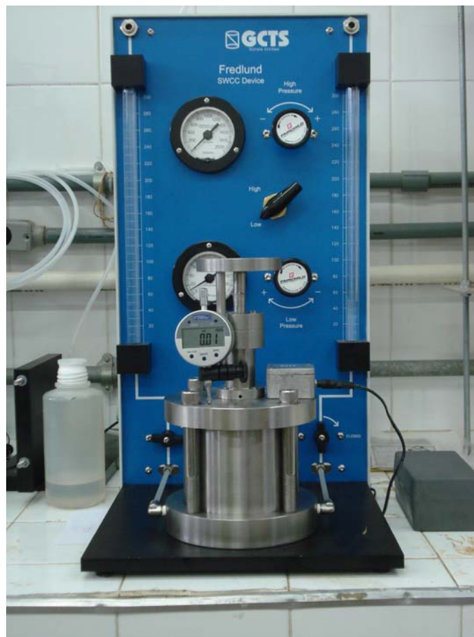
Figura 3. 56 – Aparelho de determinação da curva característica de Fredlund.
