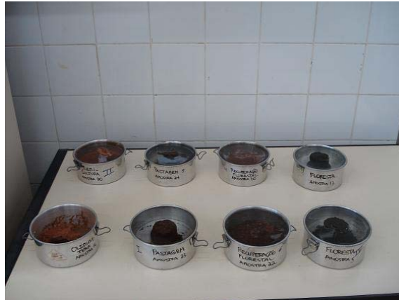
Figura 3. 64 – Ensaio de desagregação.
