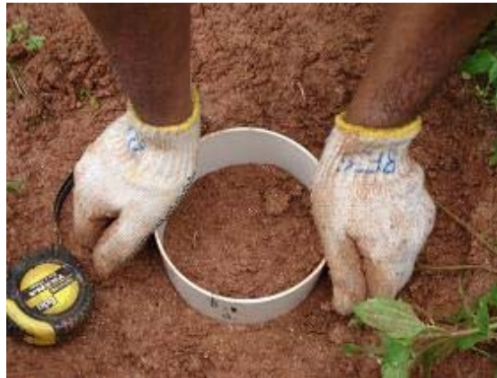
Figura 3. 5 - Cravação do anel da amostra para ensaio de Inderbitzen.
