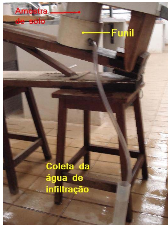
Figura 3. 63 - Coleta da água de infiltração.
