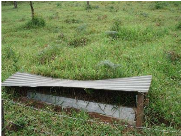
Figura 3. 17 – Parcela hidro-erosiva em época de recuperação da pastagem.
