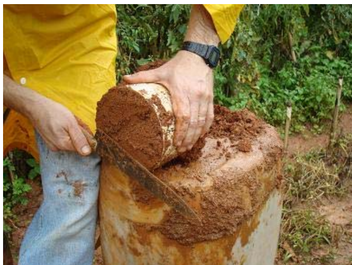
Figura 3. 7 - Rebarbas de solo sendo cuidadosamente cortadas com uma faca para preparar a amostra de solo para o ensaio de Inderbitzen.
